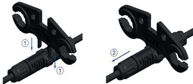
Der Verriegelungsmechanismus wird durch Drücken der Riegel mit dem Handapplikationswerkzeug geöffnet. Trennen Sie die Steckverbinderverbindung, während Sie das Spezialwerkzeug in die Verriegelung einsetzen. Ein Mechanismus der zum Drücken der Riegel und zum Auseinanderziehen der Steckverbinder fungiert.
