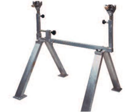
Zusatzadapter für die horizontale Montage z. B. von Endverschlüssen ist im Lieferumfang enthalten.
