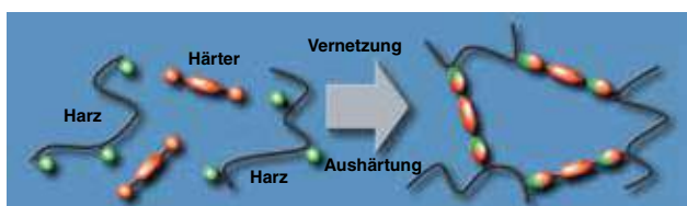
Bild 1 Schematische Darstellung der Reaktion bei Polyurethanen
