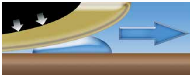
Bild 2 PowerGel - Verdrängung von Feuchtigkeit
