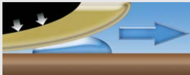
Bild 2 PowerGel - Verdrängung von Feuchtigkeit
