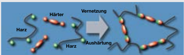
Bild 1 Schematische Darstellung der Reaktion bei Polyurethanen
