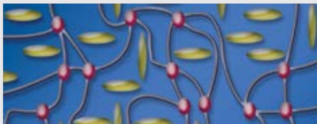
Bild 1 Polymer Matrix mit eingelagerter Flüssigkeit
