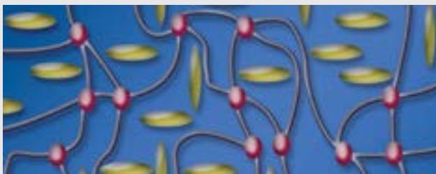
Bild 1 Polymer Matrix mit eingelagerter Flüssigkeit
