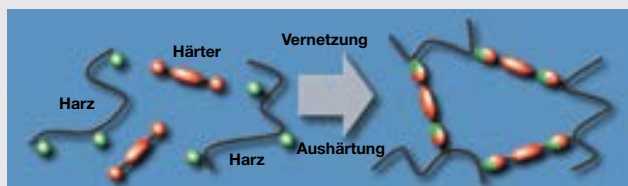
Bild 1 Schematische Darstellung der Reaktion bei Polyurethanen
