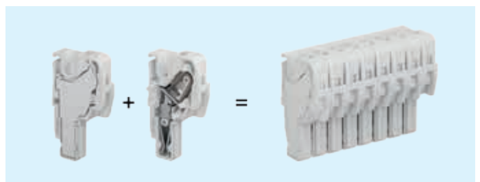
Zur Erzeugung von Kabelbäumen mit bis zu 15 Polen sind nur 2 Steckervarianten erforderlich.
