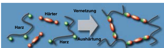
Bild 1 Schematische Darstellung der Reaktion bei Polyurethanen
